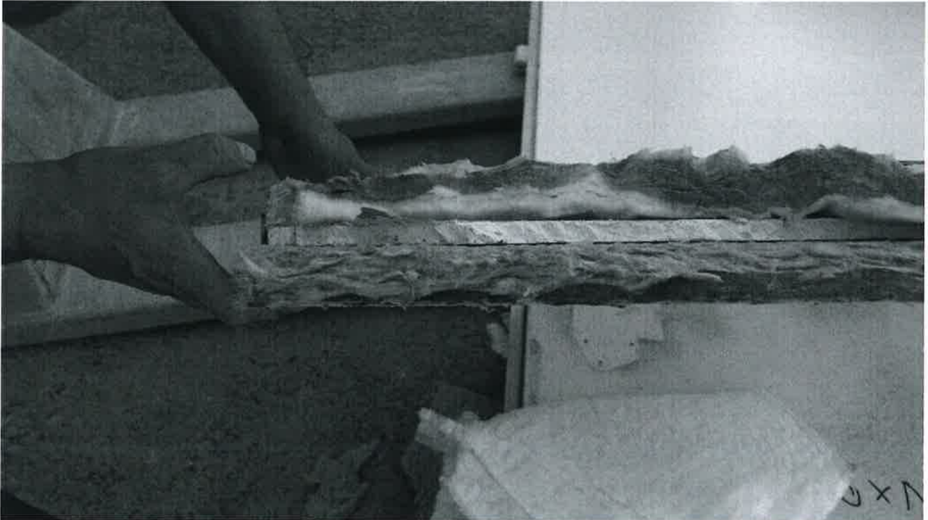
Şekil 21 Doğrulama Numunesi Kanat Kesit Görünümü (Seramik Yünü + Alçı Levha + Taş Yünü)
